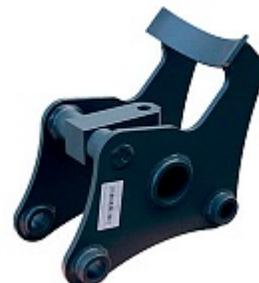
Основное отличие двухпальцевого адаптера с упором от адаптера без упора - в удобстве перевозки гидробура и бурового инструмента при передвижении техники с места на место. При наличии двухпальцевого адаптера с упором есть возможность «поджимать» буровой инструмент к экскаватору, как это делается в случае с ковшом «обратная лопата».
