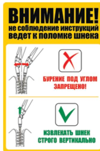
Если, при попытке вынуть буровой инструмент, заполненный грунтом, возникает сильное сопротивление, переключите вращение бура на реверсное и, медленно, поднимайте его из скважины в вертикальном положении.
